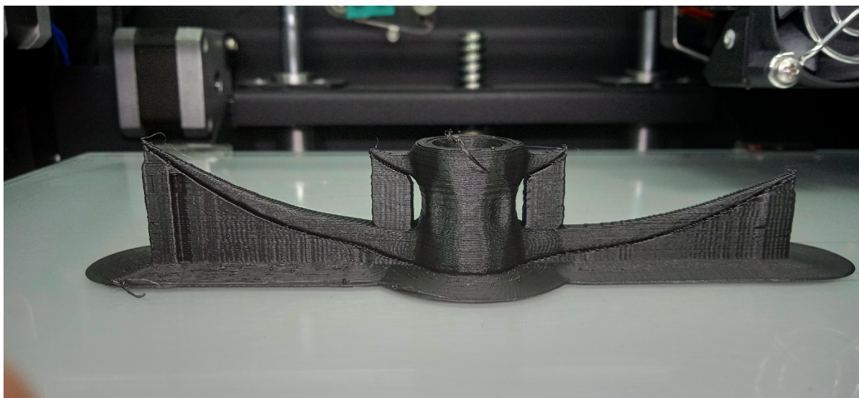
Рис. 5. Процесс создания масштабированной модели амфицельного позвонка путем FDM-печати
